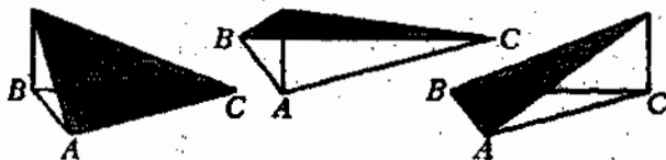
Рис. 17. Базис Лагранжа, ассоциированный с треугольной интерполяцией
